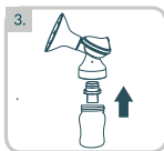
3. Вставляйте клапан в муфту. Покройте бутылку для молока для соединения, вращая его по часовой стрелке к ощущаемому сопротивлению
